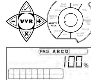
El significado del aporte de agua es multiplicar por un coeficiente los tiempos de riego seleccionados para cada estación. Si el aporte de agua es 100%, los tiempos de riego reales de cada estación son los ajustados, pero si el aporte es del 50%, los tiempos se reducen a la mitad, o si es del 250%, los tiempos se multiplican por 2,5. Por ejemplo, si el tiempo seleccionado para una estación es 10 minutos, se obtendrían los siguientes tiempos de riego reales dependiendo del aporte de agua:
