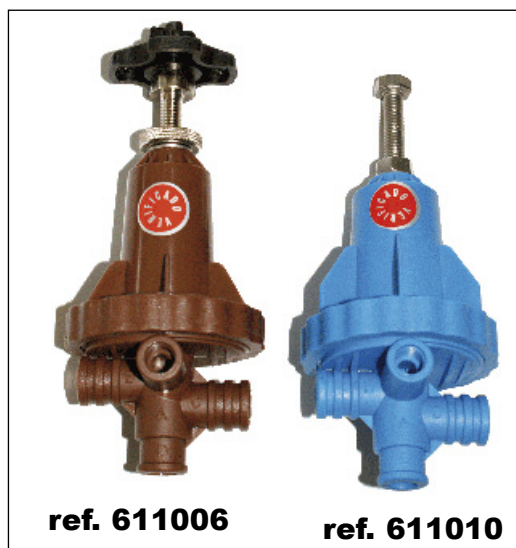
Pilotos Reductores de Plástico MARRON: 6 BAR / AZUL: 10 BAR
