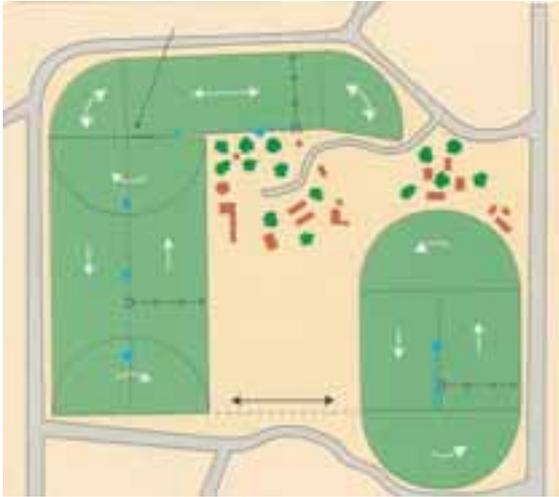
Ejemplo de diferentes áreas regadas mediante un pivote lateral multidireccional
