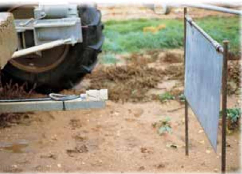
*Detalle del sistema electromagnético para detección de final de trayecto en un pivote lateral multidireccional*
